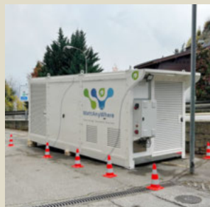
Projekt WattAnyWhere: Erzeugung von emissionsfreiem Strom aus Ethanol
